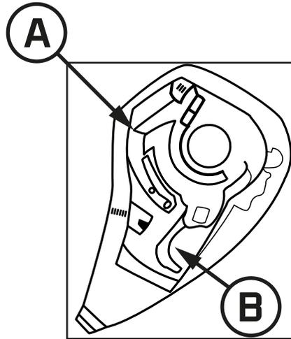
Para cambiar el visor, súbalo hasta la última posición zona [A], y accione la palanca [B] ubicado en el sistema y hale el visor hacia afuera, para ponerlo nuevamente ubique el visor en la posición más alta [A] y accione la palanca [B] sistema, encaje el visor y haga presión hacia adentro hasta oír un clic.
