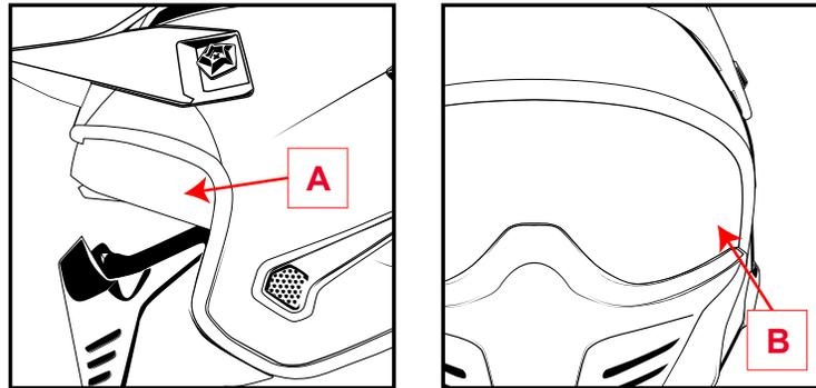
Baje el visor hasta la última posición figura [A] y tire hacia delante para retirarlo, para colocar nuevamente, ingrese las puntas del visor por las cavidades como lo muestra la figura [B], súbalo hasta escuchar un clic.
