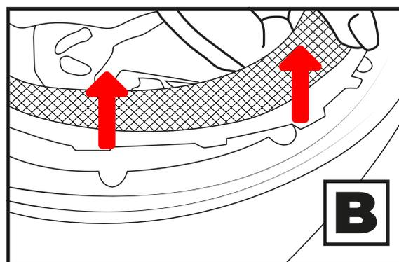
2. Cacheteras, ingrese por el orificio el sistema de retención, una vez que la almohadilla de la mejilla haya entrado completamente en su posición, presione los broches.
