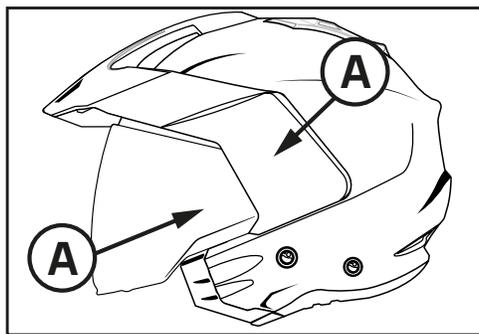
Suba el visor hasta la última posición figura [A], hale la visera para retirarla figura [B], luego hale el visor hacia afuera, para ponerlo nuevamente ubique el visor en la posición más alta y presione para que encaje, luego proceda a colocar nuevamente la visera.
